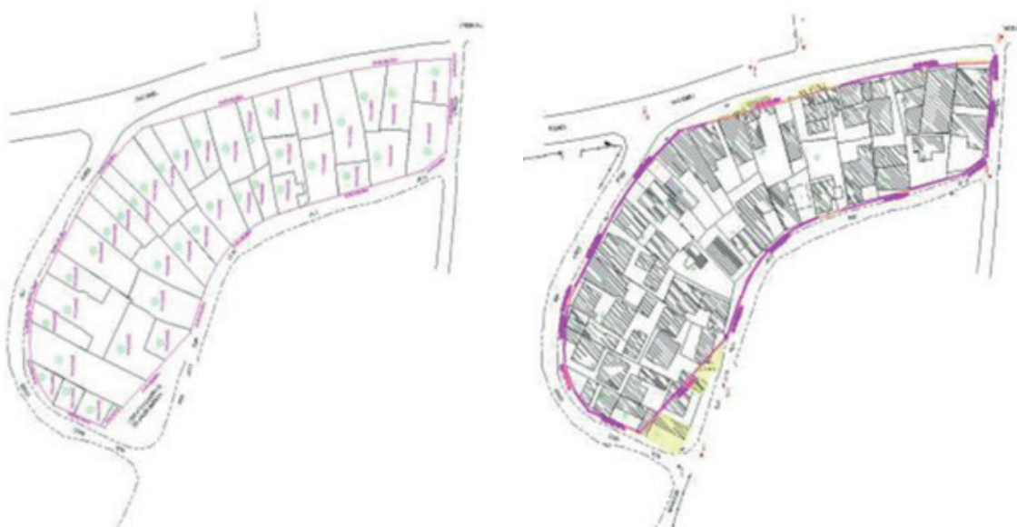
Fig 5: Detalhes da restituição topográfica por quadra/lote (proposta fundiária). Fonte: Prefeitura de Várzea Paulista; elaboração do autor.
